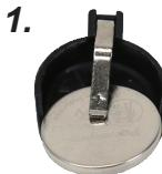
1枚目の電池を+側を上にして、押し込みます。
