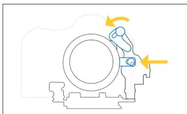
レバーを倒し、連結ギアを左に押します。固定プレートに取り付けたマウントアダプターキットとドロップインマウントアダプターのギアが噛み合い作動することを確認します。
