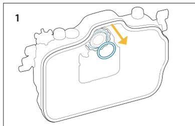
ファインダー下部の切り欠きを利用して保持用Oリングを外します。
