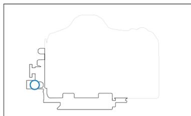
固定プレートの小さな連結ギアが、背面から見て左側にあることを確認してください。レンズの着脱を確認してください。
