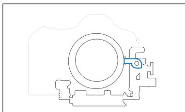
EF マウントレンズを取り付ける前に、固定プレートの EF レンズリリースレバーを水平方向に起こします。
