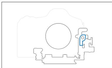
RF マウントレンズを取り付ける前に、固定プレートの EF レンズリリースレバーを垂直方向に倒し RF レンズとの干渉を避けます。
