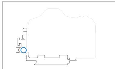
固定プレートの小さな連結ギアが、背面から見て右側にあることを確認してください。レンズの着脱を確認してください。
