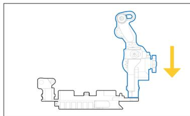
「NA Canon ドロップインフィルターマウントアダプターキット」を固定プレートに取り付けます。
