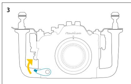
ポートリリースレバーを起し、ポートをロックします。カチッという音がしてレバーが固定されたことを確認してください。
