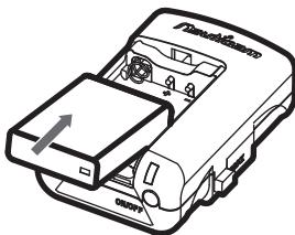
端子を正しい向きに合わせてバッテリーを装填し、カバーを元に戻します。
