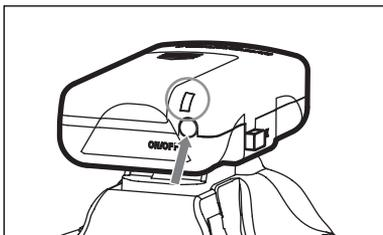
ハウジングを閉じる前に、本体のON/OFFボタンを1秒以上長押ししてレディランプの点灯を確認します。
