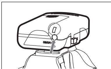
ハウジングを閉じる前に、本体のON/OFFボタンを1秒以上長押ししてレディランプの点灯を確認します。
