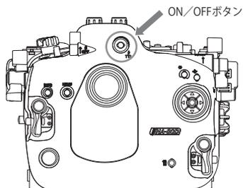
ハウジングの「TTLコンバーターON/OFFボタン」を1秒以上長押ししてランプの点灯を確認します。
