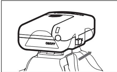
取り付け脚がカメラのアクセサリシューの奥に突き当たるまで差し込みます。
