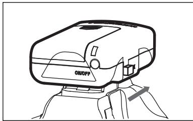
取り付け脚がカメラのアクセサリーシューの奥に突き当たるまで差し込みます。
