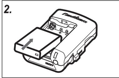
端子を正しい向きに合わせてバッテリーを装填し、カバーを元に戻します。
