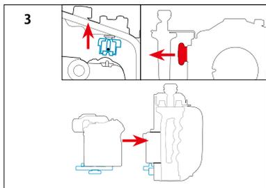
カメラを取り付ける前に、ON/OFFレバーを持ち上げます。レンズのギアが干渉しないようにズーム/フォーカスノブを引き出しながら、固定プレートをレールに沿ってハウジングにスライドさせて戻します。ズーム/フォーカスノブを元の位置に戻します。
