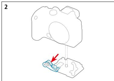
固定プレートのネジをカメラの三脚ソケットに締めて、カメラを固定プレートに取り付けます。
