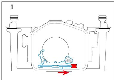
リアケースを開け、ロックレバーを矢印の方向に開いてカメラ固定プレートを引き出します。
