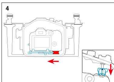
固定プレートのロックレバーを矢印の方向に戻し、トレイを固定します。ハウジングとレンズのギアがかみ合っていることを確認し、ON/OFFレバーをゆっくりと下に押して、カメラのレバーとかみ合っていることを確認します。ハウジングのリアボディを取付け、カメラが正しく作動するか確認してください。
