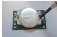
ノーティカムハウジングにはリークセンサーが標準装備されています。万一、ハウジング内に浸水が発生した場合、音とLEDの発光で知らせます。ご使用前に以下の手順でセンサーの状態を確認してください。
