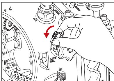
5. ハウジングのポート開口部に汚れや異物が付着していないこと、Oリングの溝にゴミなどが付着していないことを必ず確認してください。
