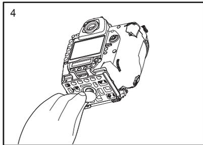
5. スライドバーの上部にある、AF/MF切替ノブの位置をカメラのフォーカスモードセクターダイヤルに合わせて、スライドバーを内側に押し込みます。AF/MF切替ノブを回し、カメラのフォーカスモードが正しく動作するか確認してください。(図5)
