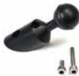
M5のねじ穴に対応したベースアダプターです。傾斜角は45度。ネジとネジとの間のピッチは18mm。
